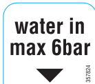
Para evitar danos no equipamento a pressão da água não deverá exceder 6 bar.
